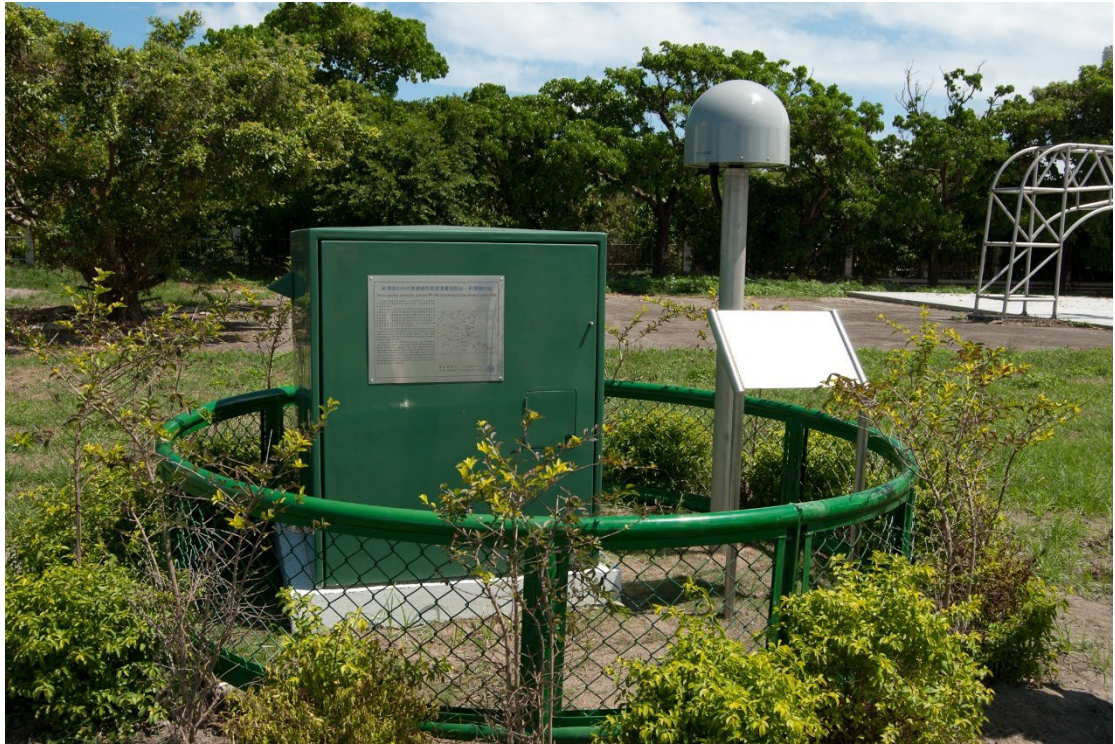
圖 7：GNSS 連續追蹤站，測站設於透空度良好地點，天線罩內為天線，使用穩定之電力系統接收衛星訊號，透過網路傳送觀測資料。
