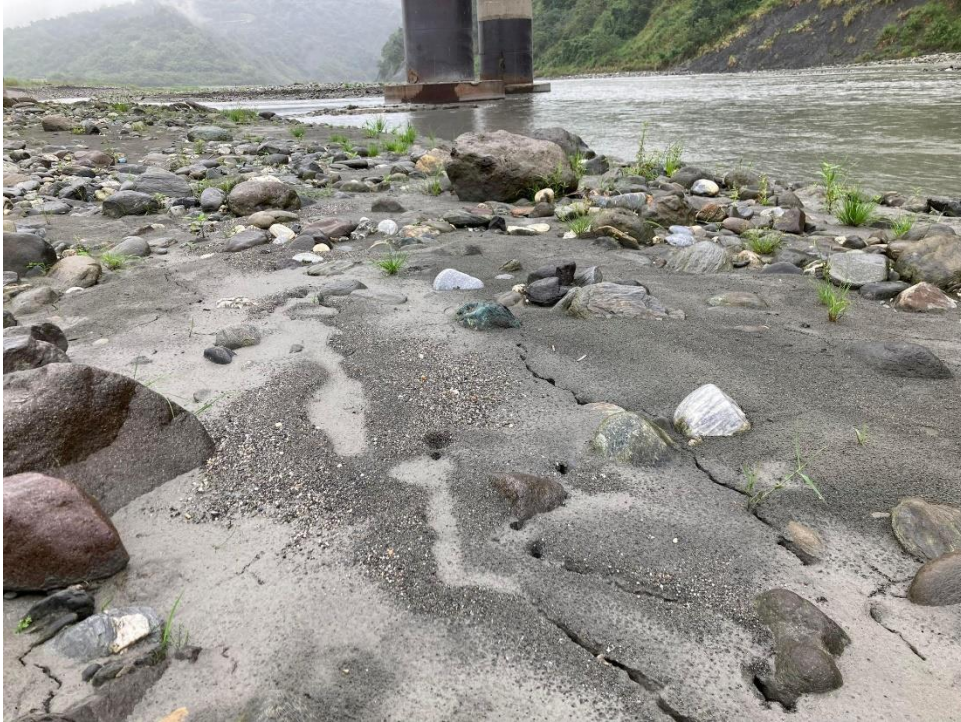
圖 27、瑞穗大橋附近具小規模液化噴砂現象（旺財應用地質技師事務所提供）。
