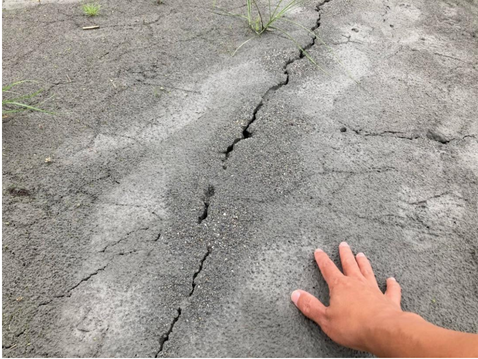
圖 25、玉里大橋下具小規模液化噴砂現象。
