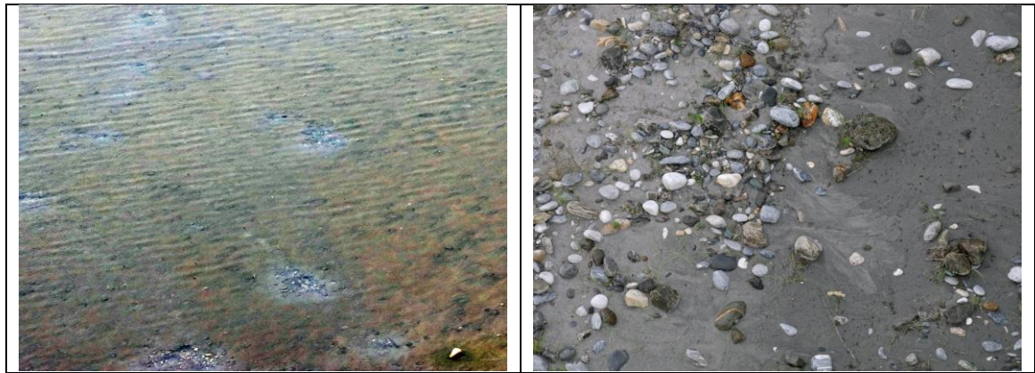
圖 30、花蓮縣壽豐鄉，米棧大橋下水下（左，陳盈璇攝）與西側沙洲（右，劉彥求攝），小規模噴沙與裂隙。
