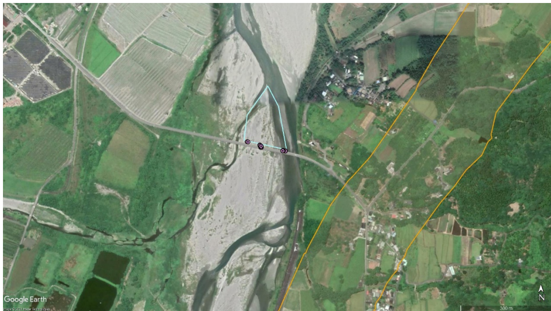
圖 12、點位 2 中興橋北側沙洲（北側點位）液化，位在點位 1（南側點位）的北北東方約 1.5 公里處，液化範圍沿沙洲邊界朝約 N70E 延伸至少 200 公尺。
