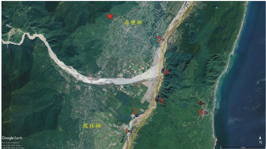
圖 8、本次地震後，花蓮溪河床與水璉出現噴砂等液化現象或結構受損區域簡圖。1：中興橋下、2：中興橋北側、3：米棧南側、4：米棧北側、5：米棧大橋附近、6：水璉國小。
