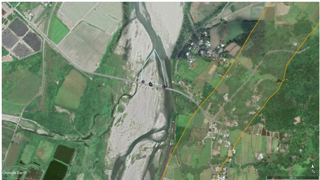
圖 9、本次地震後，點位 1：中興橋下花蓮溪河床噴砂等液化現象範圍簡圖，橘色框線內為活動斷層地質敏感區(F0020 嶺頂斷層)範圍。
