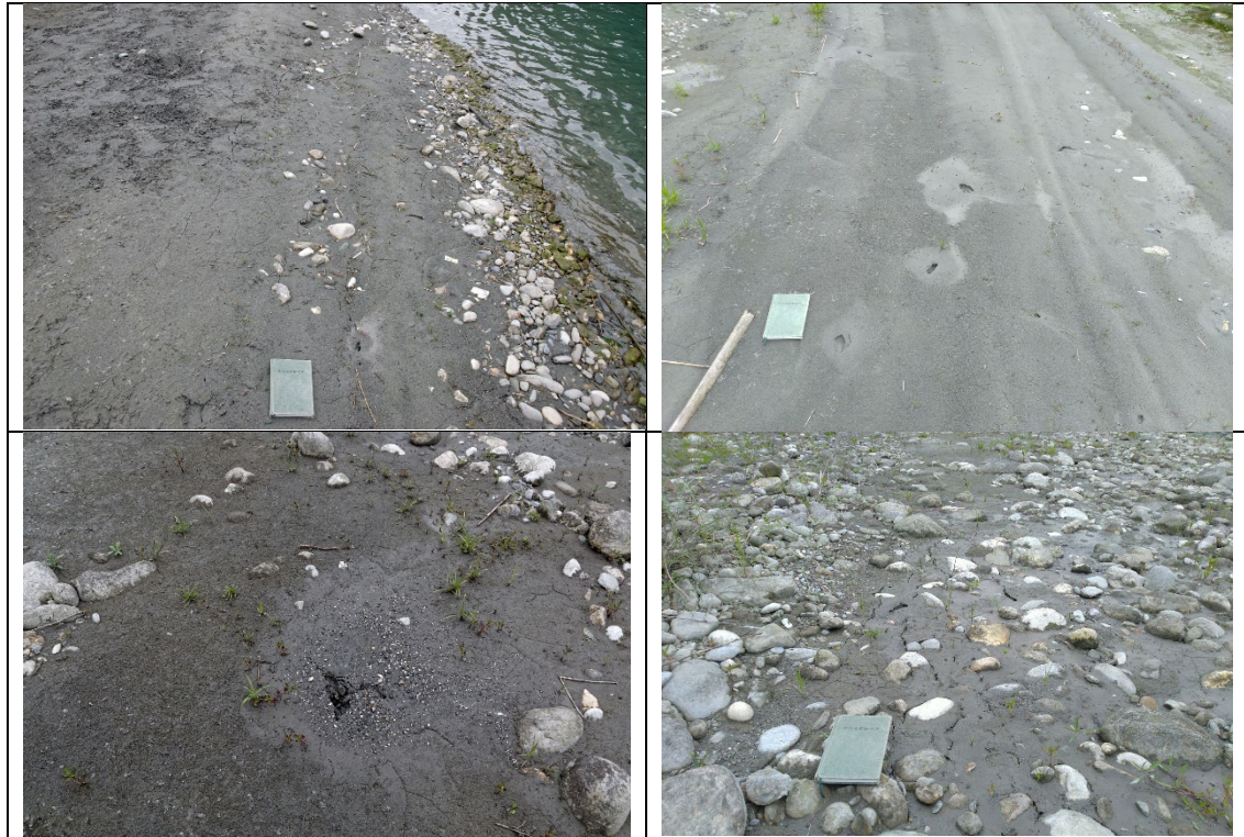
圖 17、點位 3 液化現象斷斷續續在此區域延伸，噴砂孔沿著裂隙分布。
