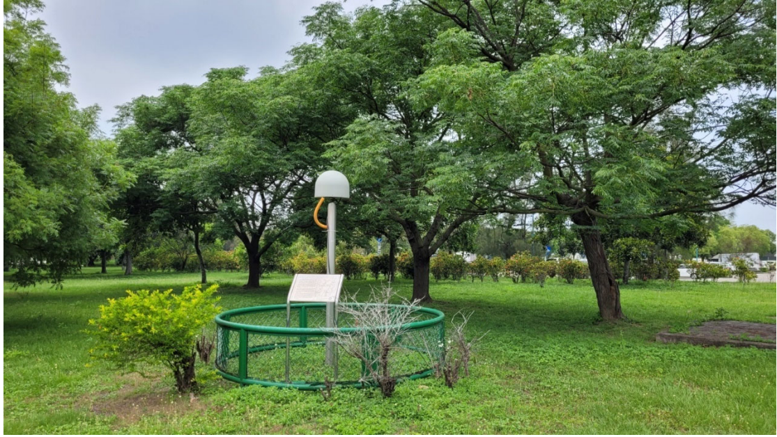
圖 37、GNSS 連續追蹤站外觀，灰色天線罩內為天線所在位置，隨時接收衛星訊號，即時透過網路將觀測資料傳至控制室處理與解算。
