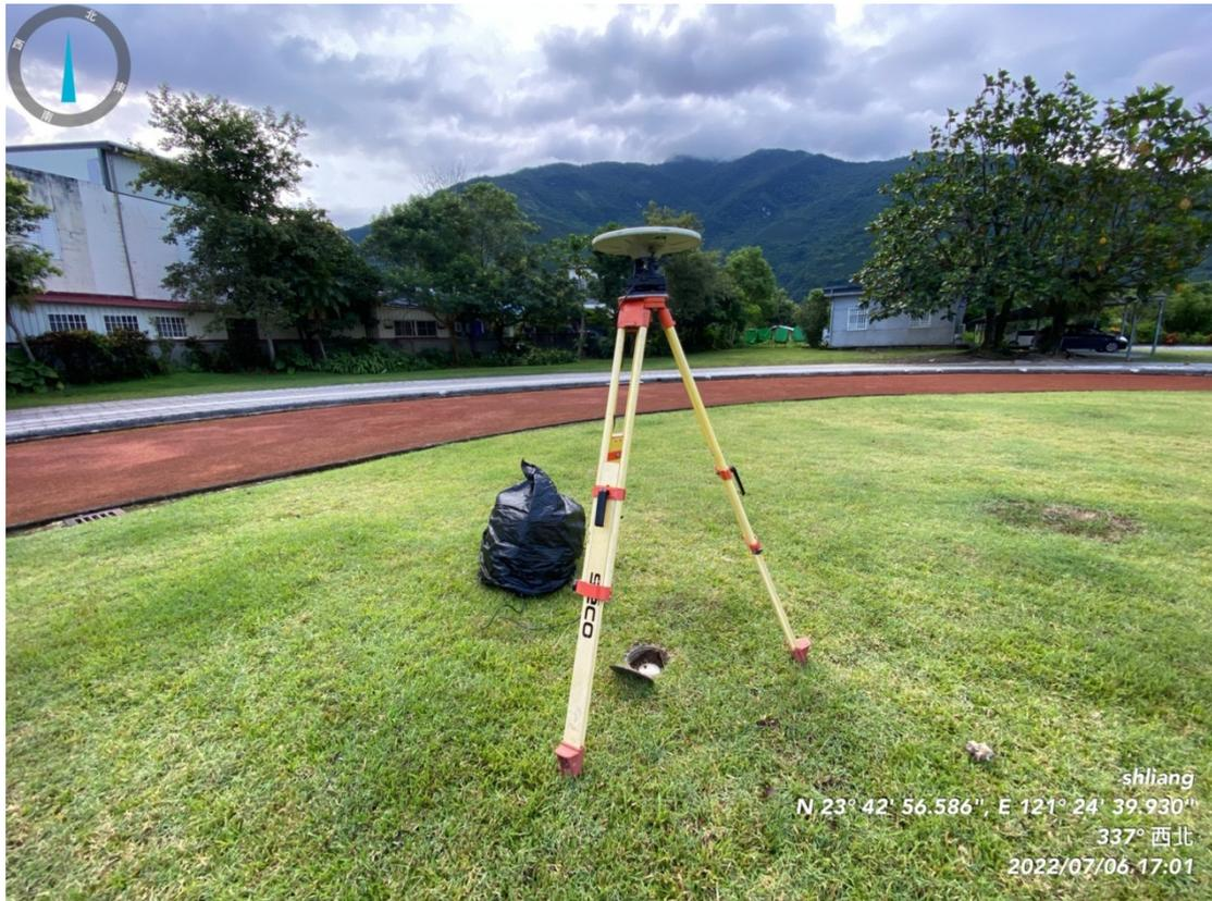
圖 2、0620 地震後，本所於野外 GNSS 移動站測量工作實例。
